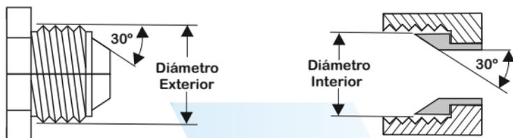
JIS 30° es una conexión de rosca BSPP y asiento de 30° en inclinación saliente en el macho y entrante a 30° en la hembra. El sistema es igual al BSPP pero invertido los asientos.
