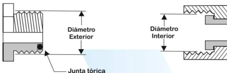
Sistema con paso de rosca recto y donde el macho incorpora una junta tórica. El asiento entre macho y hembra es de cara plana produciéndose el sellado entre macho y hembra por la estanqueidad de la tórica. La rosca garantiza mecánicamente el sellado y cierre.
